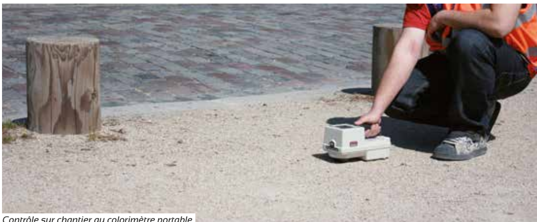
Contrôle sur chantier au colorimètre portable
